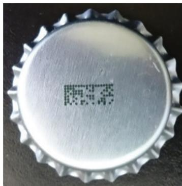
Figura 38 – Tapas con código de seguridad impreso de control de calidad y activación.
