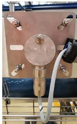
*Figura 41 – Ilustración del encoder instalado.*
