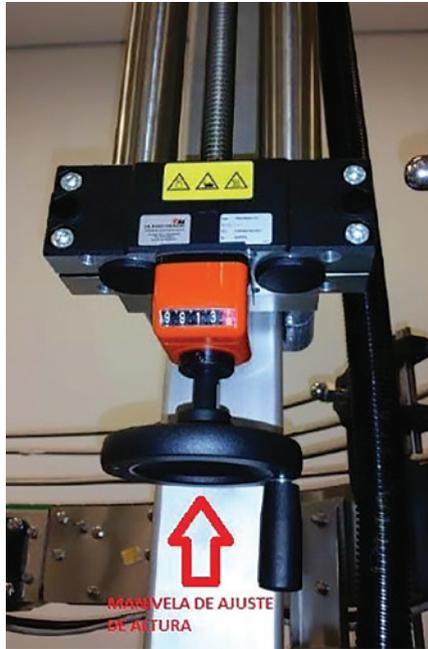
Figura 81. Ajuste de altura de sistema BEAM.
