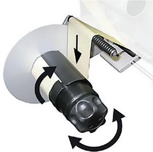
Figura 75. Ajuste de etiquetas en bobina.
